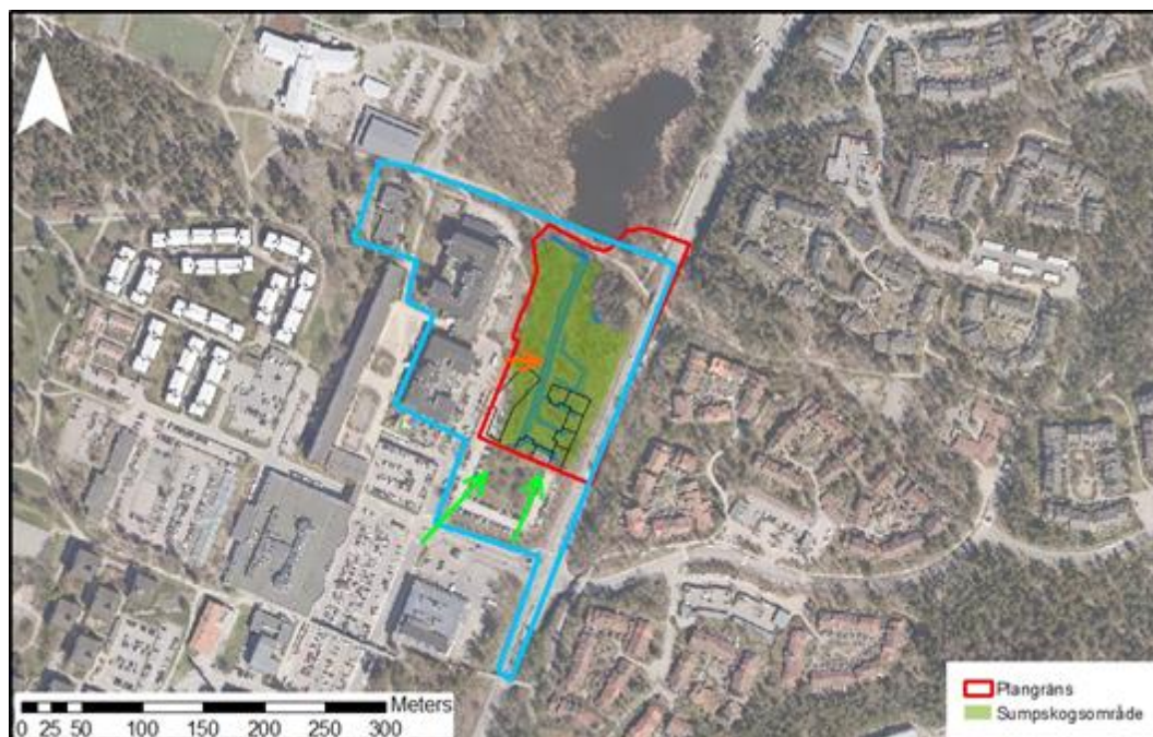
Figur 28. Befintliga dagvattenledningar (gröna pilar) och framtida ledning (orange pil).
